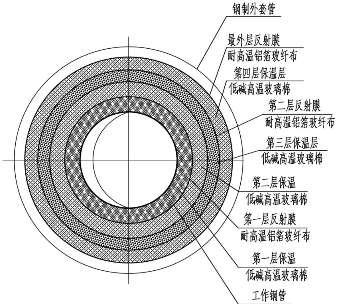
**钢套钢直埋管保温结构大样图**
